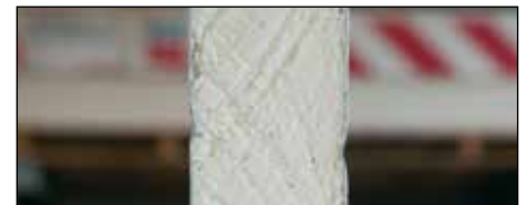
50 mm panels in PU foam
